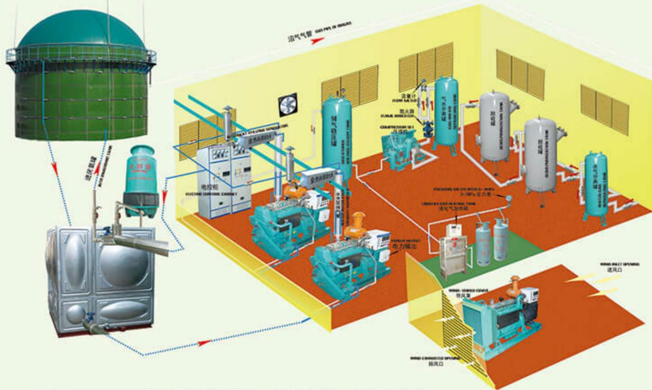
说明：从储气稳压罐往各设备底部均有排污阀门，安装过程中请预先做好排污排水渠道。
